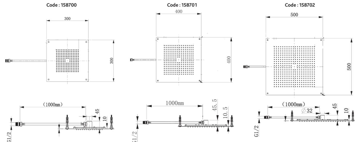
Recommandation d'encastrement : 9 cm entre plafond et faux-plafond
