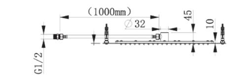
Recommandation d'encastrement : 9 cm entre plafond et faux-plafond
