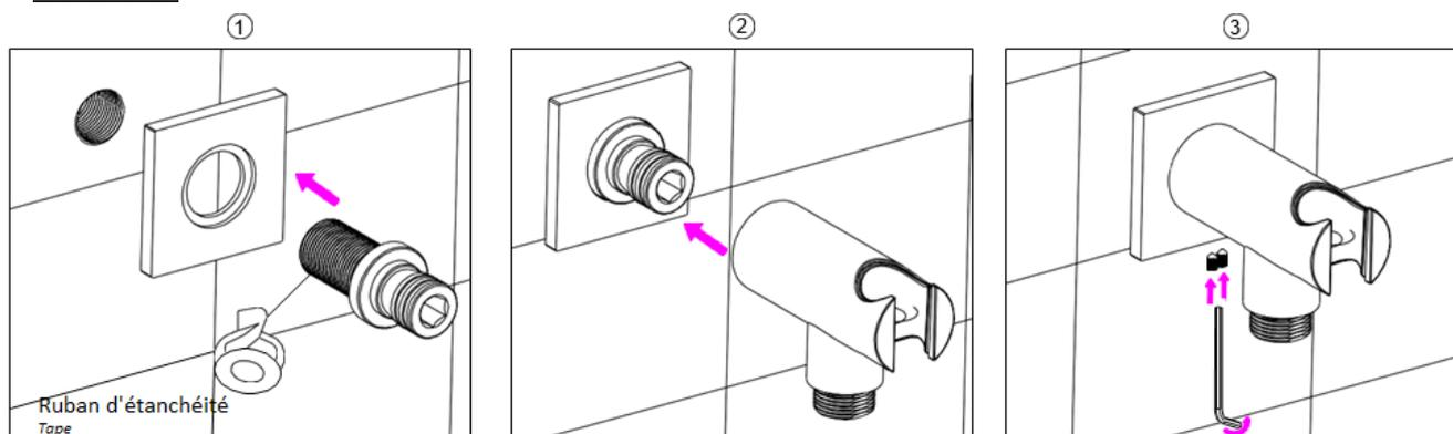
1. Enrouler le ruban d'étanchéité autour du filetage du raccord de connexion, puis utiliser la clé Allen pour fixer le raccord de connexion au mur. Veiller à installer la rosace décorative en premier.
